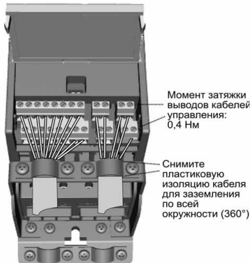
Рисунок 3.8: Смонтируйте кабели управления. См. главу 6.2
