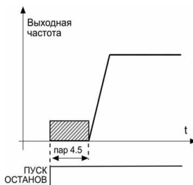
Рисунок 9.4: Время торможения постоянным током при пуске
